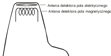
Rys.3 Umieszczenie anten detektorów w głowicy odbiornika
