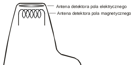
Rys.3 Umieszczenie anten detektorów w głowicy odbiornika Wartość natężenia pola elektrycznego lub magnetycznego zobrażowana
